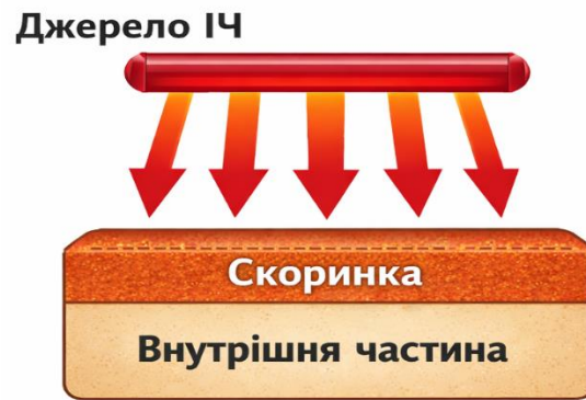
Рис. 1. Схема ІЧ-нагрівання продукту
